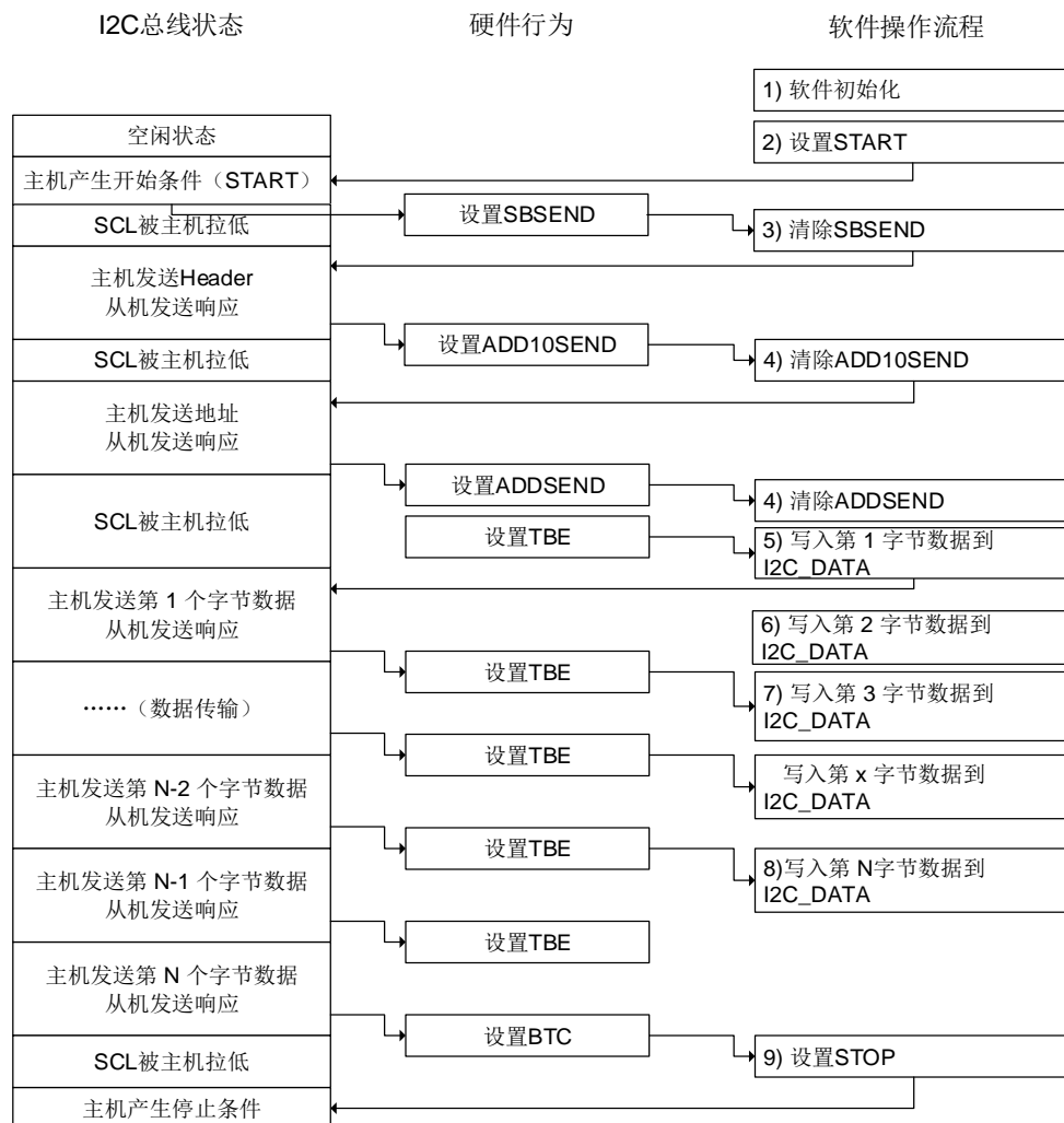
图 24-11. 主机发送模式（10 位地址模式）
