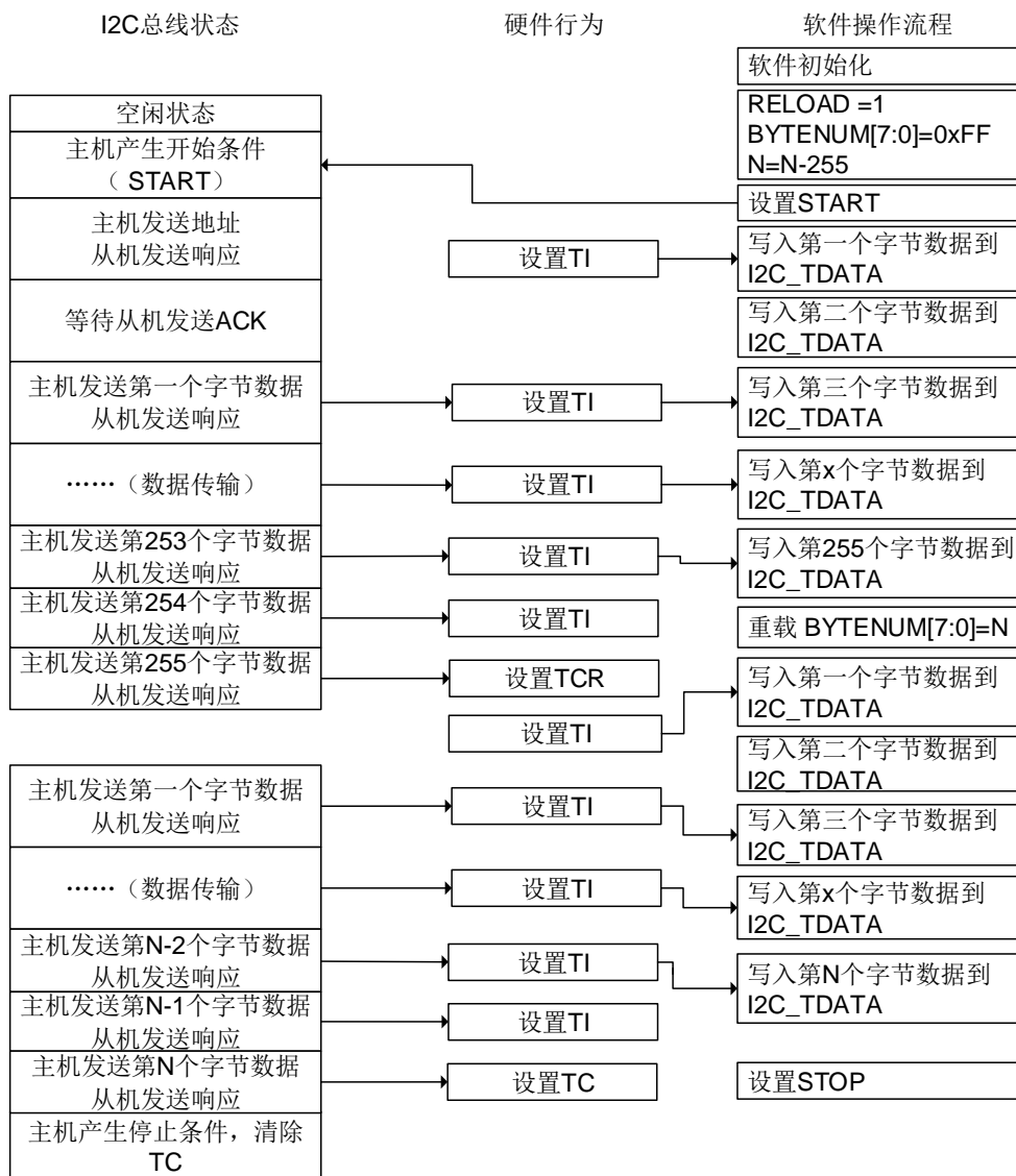
图 20-19. I2C 主机发送编程模型 (N>255)
