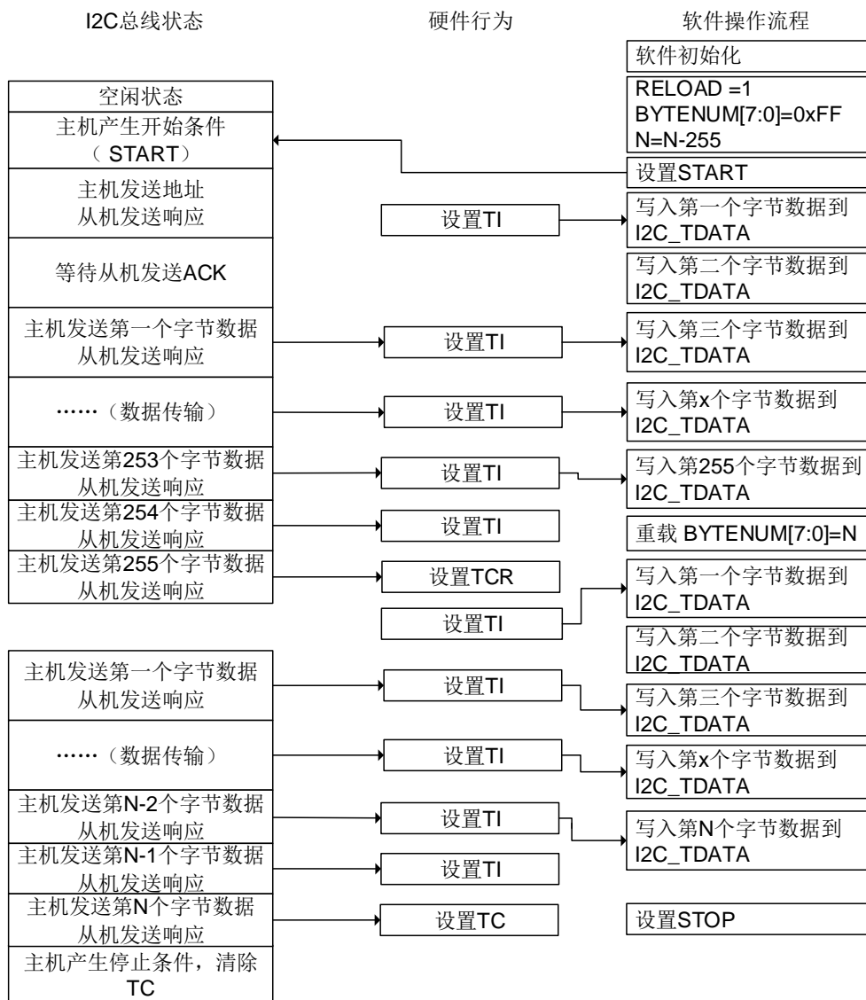
图 20-19. I2C 主机发送编程模型 (N>255)
