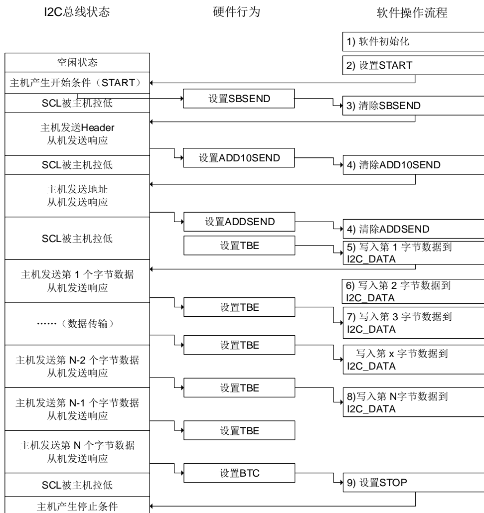
图 19-11. 主机发送模式（10 位地址模式）
