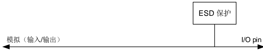
图 7-4. 模拟配置的基本结构
