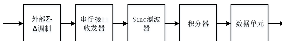
图 45-7. HPDF 模块外部输入数据处理流程
